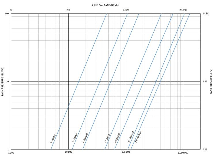
MODEL 3100 REV C PRESSURE RELIEF WIDE OPEN CAPACITY
